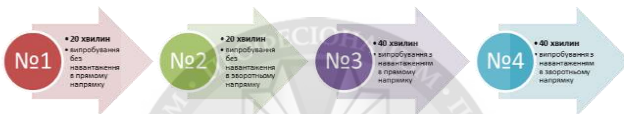
Рис. 4. Режим випробувань редукторів в ПАТ «Укрзалізниця»
