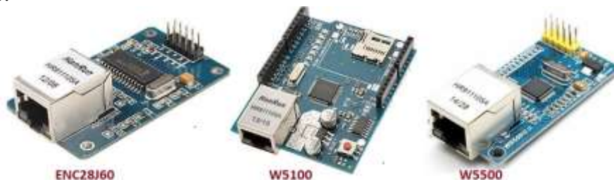
Рисунок 1 – Контроллеры Ethernet ENC28J60, W5100, W5500
