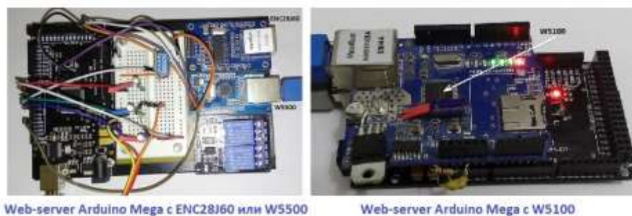
Рисунок 2 – Web-сервера Arduino Mega с сетевыми контроллерами ENC28J60, W5100, W5500
